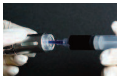
Fig 12. Pousser le disque en silicone en utilisant l'embout de la seringue...
