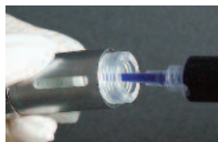
Fig 3. Pousser le disque en silicone vers le fond du dispensier en utilisant l'embout de la seringue
